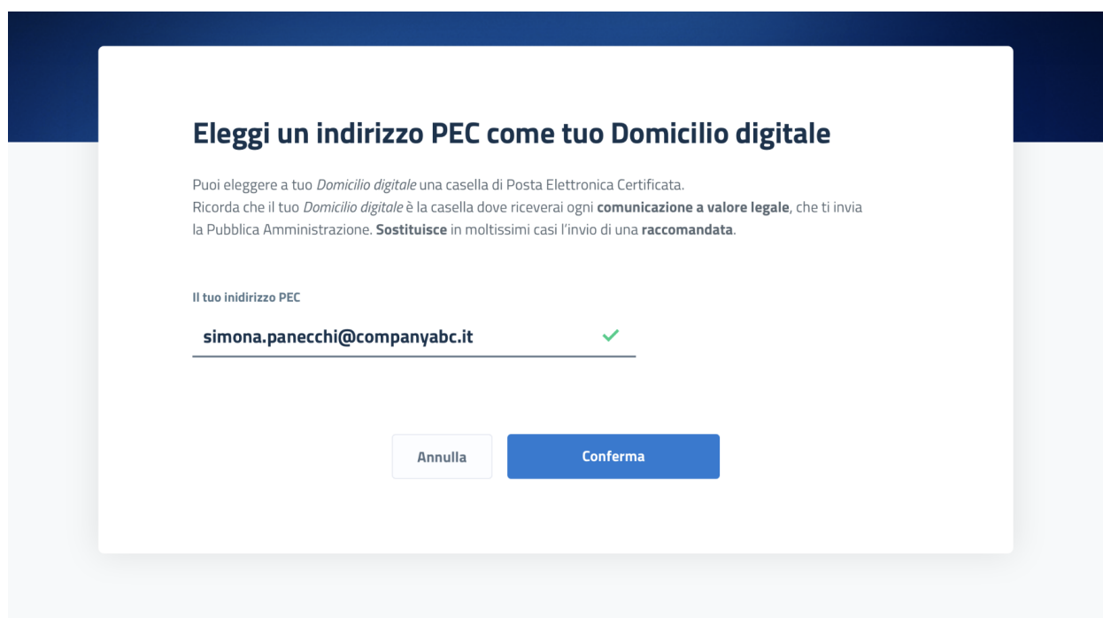
Fig. 1.26: Un esempio d'uso di un pulsante "Primary" associato ad un altro gerarchicamente inferiore. In questo caso è stato usato un "Quaternary" dello UI Kit: l'utente così è indirizzato sul pulsante primario in modo inequivocabile.
