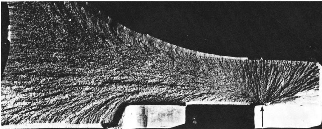
Frattura fragile in un anello a scatto – si noti la freccia che indica il punto di inizio
