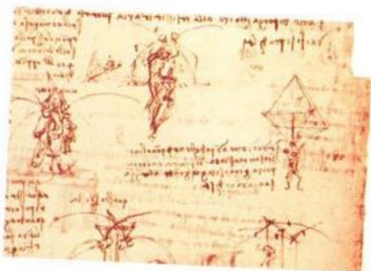
Due studi risalenti al primo soggiorno milanese: un paracadute (c. 1485, CA 1058v) e due dispositivi di volo a vela (c. 1493, Md I 64r). Negli ultimi anni Leonardo vede nel volo a vela e aerostatico l'unico tipo di volo possibile.
