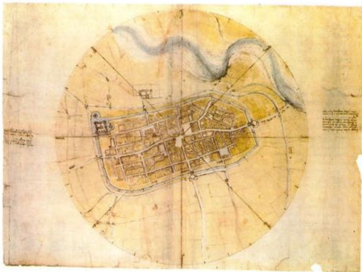
Mappa di Imola (RL, 12284) e, in basso, rilievi topografici preliminari (RL, 12686r). Leonardo ha prima misurato la città strada per strada («analisi»); ha quindi, nella mappa definitiva, ricucito insieme le misure particolari, raccordandole in modo proporzionale con l'ausilio di un goniometro («sintesi»).
