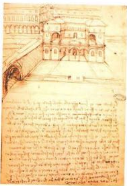
Progetti per una città attraversata da canali (Ms. B 16r); per un tempio a pianta centrale (Ms. B 17v); per il tiburio del duomo milanese (CA 850r). Nel primo esempio domina il movimento dei fluidi; nel secondo la geometria, nel terzo nozioni di statica e dinamica.
