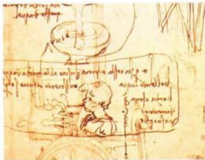
«Testa di moro»: portando a ebollizione l'acqua di cui è stato riempito questo mezzo busto, dalla bocca esce vapore (CA 1112v).
