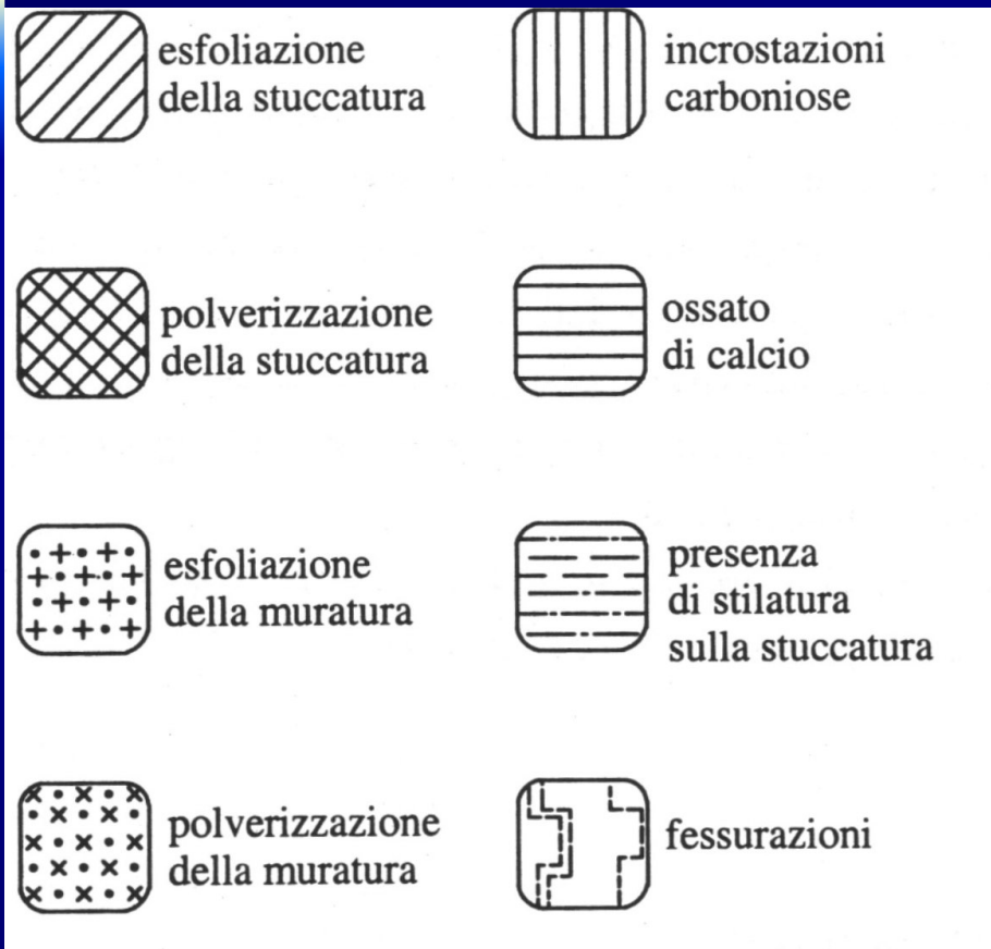
Tavola per il rilievo del quadro fessurativo e delle patologie di degrado (immagine tratta da Olivito, op. cit.)
