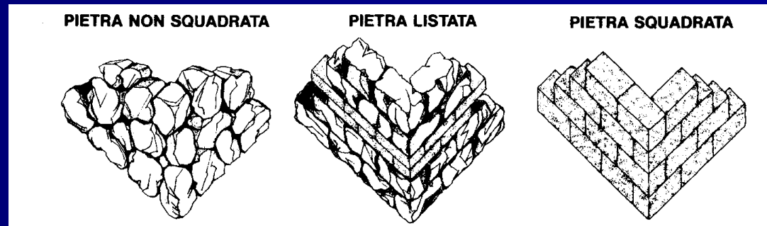
Esempi di murature in pietra naturale. Immagine tratta da Sbacchis, op. cit.
