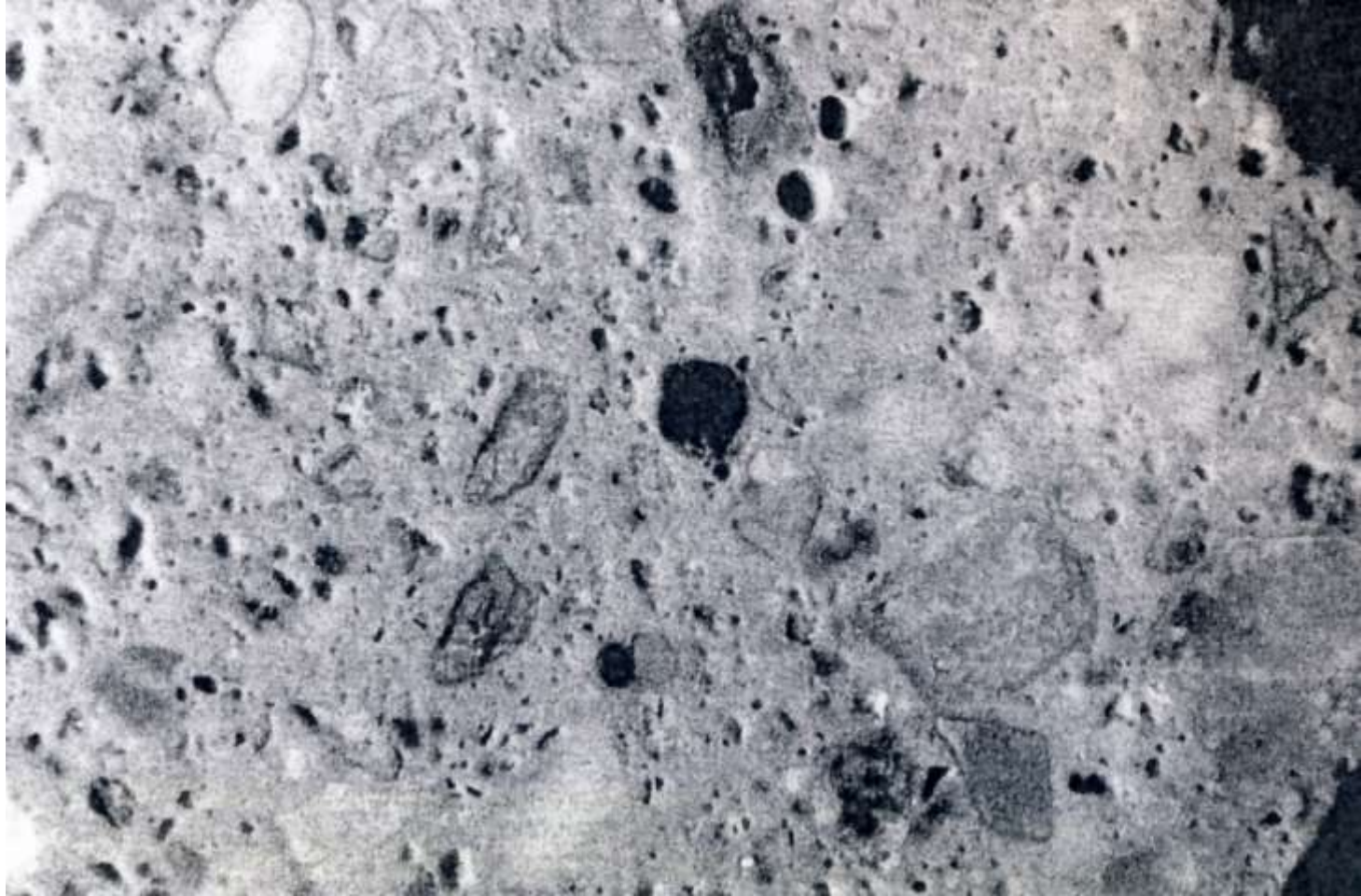
Sezione di un campione (Sud Germania) di malta con aggregato e matrice in gesso
