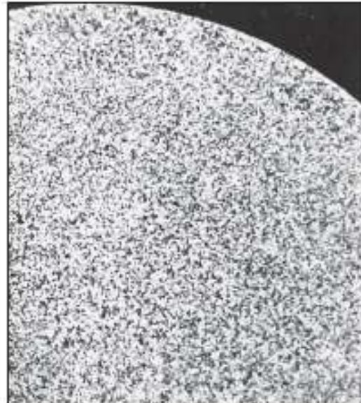
Struttura a grani di alluminio fuso con (a) e senza (b) raffinatori di grano
