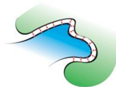
FIGURA 2.6 Forze di van der Waals. (a) Quando due atomi si avvicinano l'uno all'altro, risentono di una debole forza di attrazione, che aumenta fino ad una distanza di circa 4 Å. Se gli atomi si avvicinano di più, le loro nubi elettroniche si respingono ed essi tendono a separarsi. (b) Sebbene una singola forza di van der Waals sia molto debole, numerose forze attrattive di questo tipo si possono formare se le due macromolecole hanno superfici complementari, come indicato schematicamente nella figura (vedi Figura 2.40 per un esempio).
