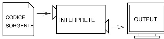
Figura 1.1: Un interprete elabora il programma un po' per volta, leggendo le righe ed eseguendo i calcoli alternativamente.
