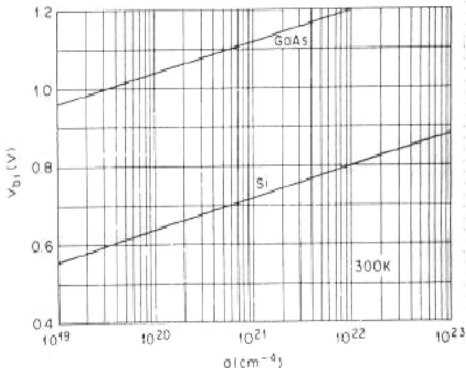
Variatione di  $V_{bi}$  per giunzioni a gradiente lineare in Si e GaAs in funzione del gradiente di impurita'  $a$ .
