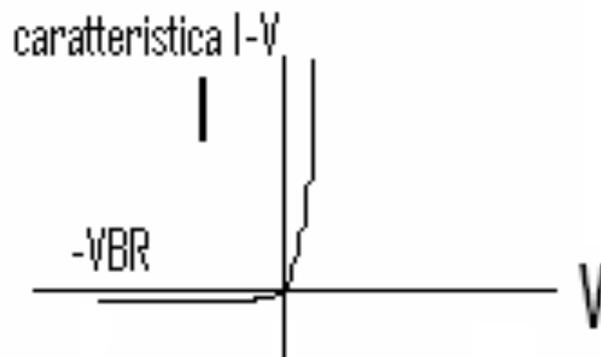
Tale figura indica il simbolo e la definizione per correnti e tensioni positive. Se alla zona p e' applicata una tensione positiva rispetto alla zona n, il diodo viene detto in polarizzazione diretta e la corrente cresce rapidamente con la tensione. Quando invece alla zona p e' applicata una tensione negativa il diodo e' detto in polarizzazione inversa e il flusso di corrente sara' molto basso
