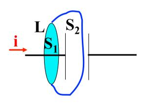
Se consideriamo la superficie  $S_1$  delimitata dalla linea L ed applichiamo Ampére, abbiamo che la circuitazione del campo magnetico B risulta proporzionale alla corrente i che scorre nel circuito ed arriva alla prima armatura del condensatore. Se invece consideriamo  $S_2$ , delimitata da L, abbiamo in entrata la corrente i, ma non registriamo alcun flusso uscente
