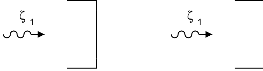
Fig. 3: Schemi equivalenti a un C.E.P. e a un C.M.P. per il calcolo di \Gamma
