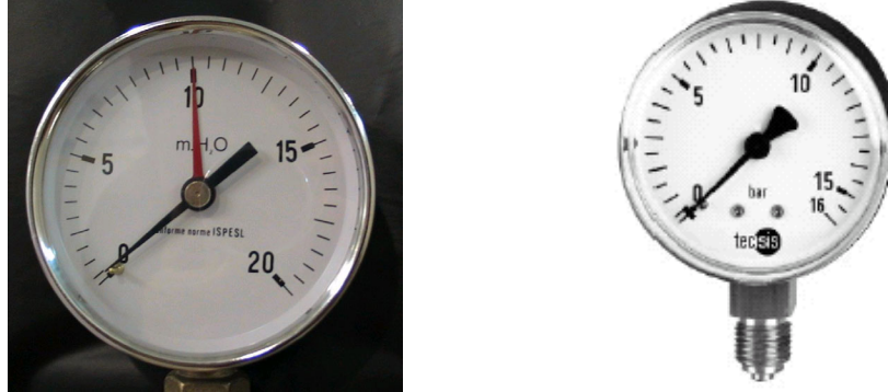
Figura 29. Esempi di manometri metallici con diverse scale di graduazione.
