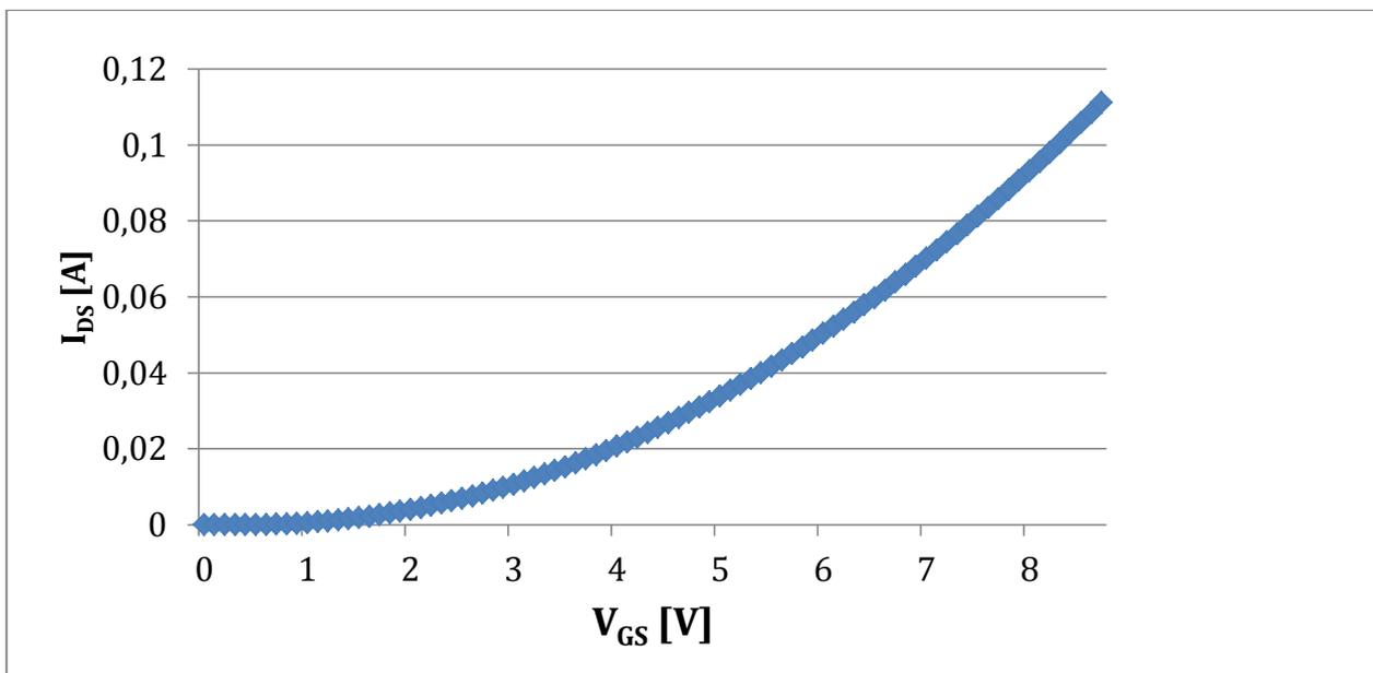
Di tale transistor si conosce inoltre il drogaggio del substrato ( $N_B = 10^{17} \text{ cm}^{-3}$ ) e che  $q\phi_{MS} = -1 \text{ eV}$ .
