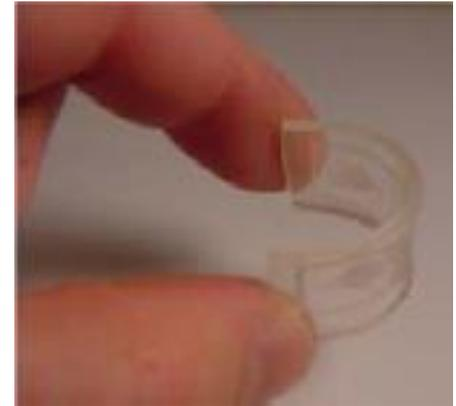
La natura elastica del materiale permette di realizzare un **“Conformal Contact”** su qualsiasi superficie
