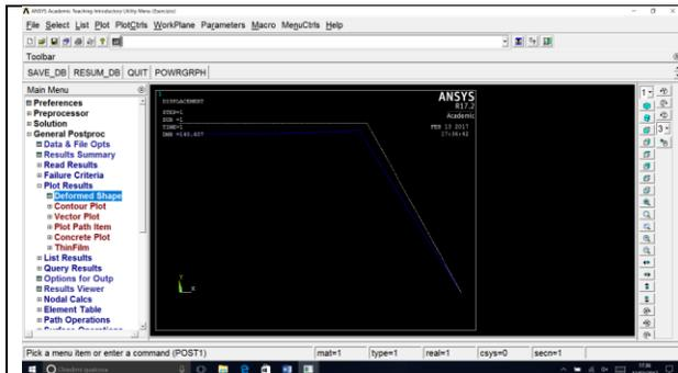
Fig. 1 – Deformata: lo spostamento del pattino A, in direzione parallela al terreno, vale circa 140.6 mm.
