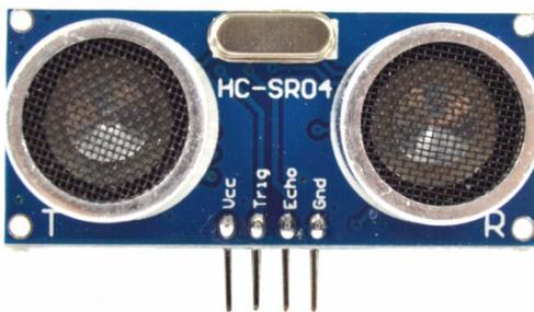
Il sensore ad ultrasuoni dispone di 4 pin: VCC, Trigger, Echo e GND. Il sistema emette delle onde sonore dal pin Trigger e riceve sul pin Echo la misura del tempo di rimbalzo contro un
