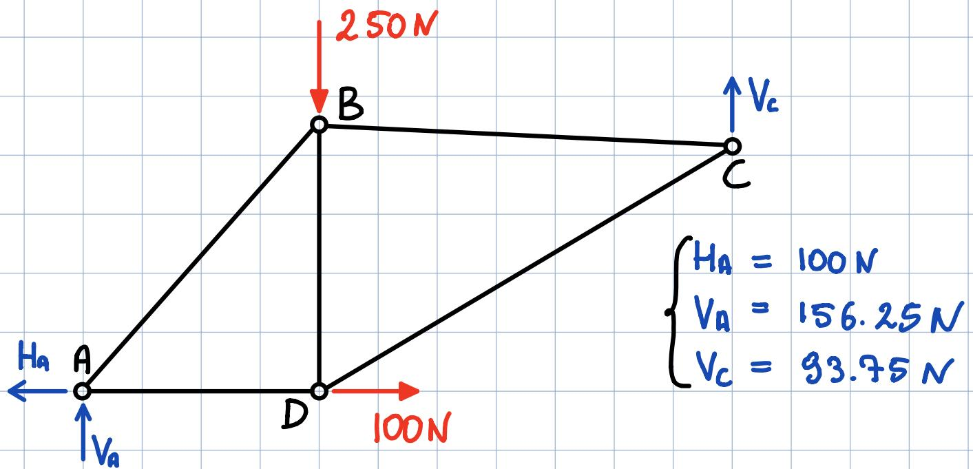
È evidente come la struttura sia del tipo **reticolare**, con i corichi localizzati sui nodi.
