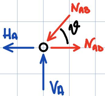
Abbiamo a disposizione solo due equazioni di equilibrio nodale (traslazione verticale e orizzontale), poiché l'equilibrio alla rotazione fornisce un'identità.
