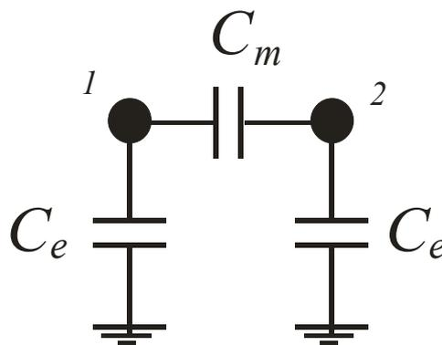
Figura 6.3: diagramma delle capacità per il caso  $N=2$  con due conduttori uguali
