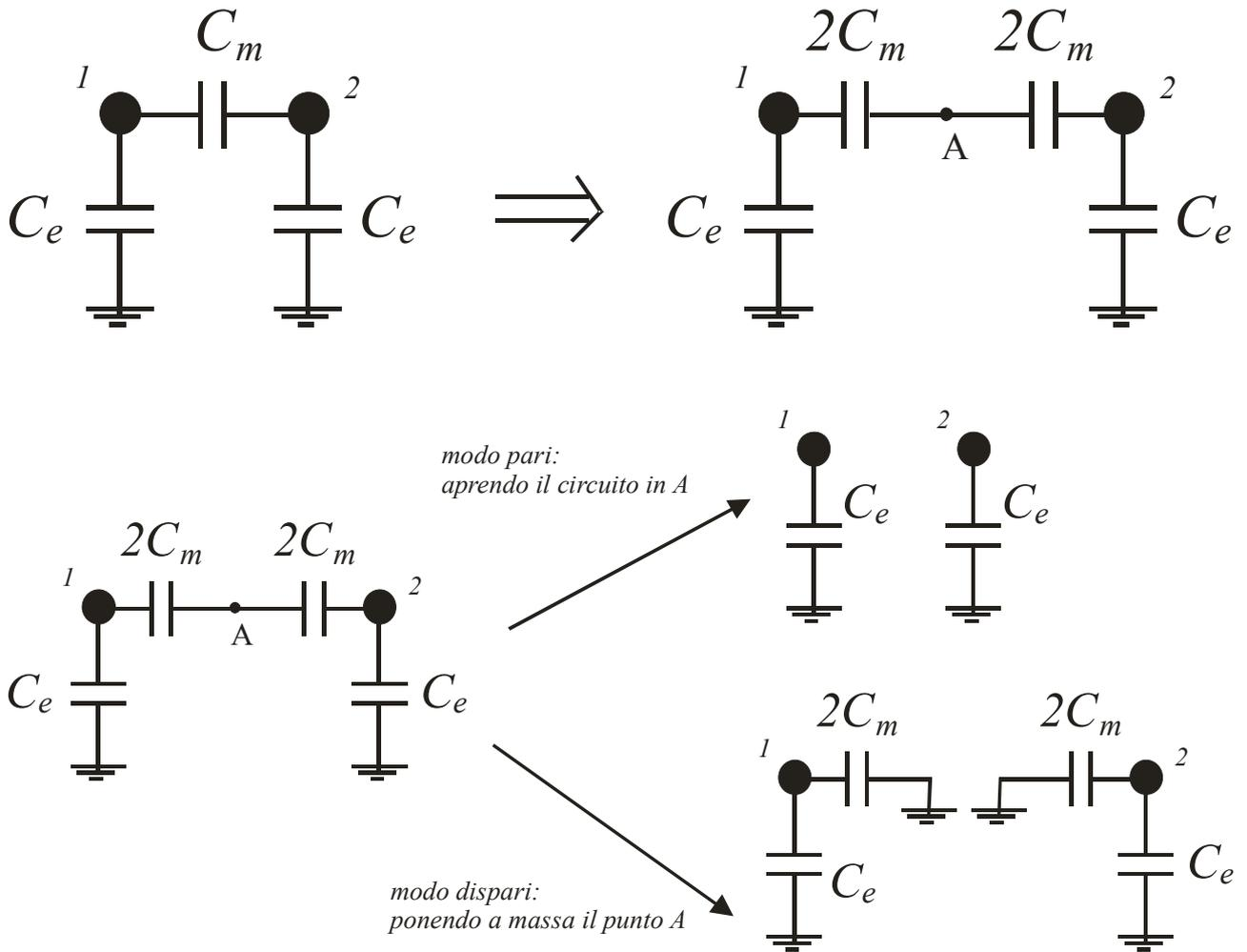
Figura 6.4: diagramma delle capacità per il caso  $N=2$  con due conduttori uguali, analisi del modo pari e del modo dispari.
