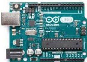
Qui risiede il microcontrollore ATmega328P che esegue le istruzioni ed elabora in un loop infinito un programma scritto in linguaggio C. Dispone di 14 pin di input/output digitali, di cui 6 utilizzate come uscite PWM, 6 ingressi analogici. L'alimentazione può essere collegata direttamente con batteria 12V o tramite ingresso usb al pc ed è in grado di avere 2 tipi diversi di uscite in volt: 5V e 3,3V.
