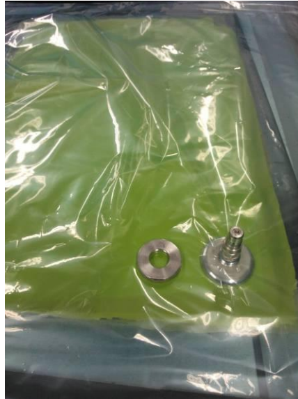
Figura 11: Posizionamento della valvola per la creazione del vuoto
