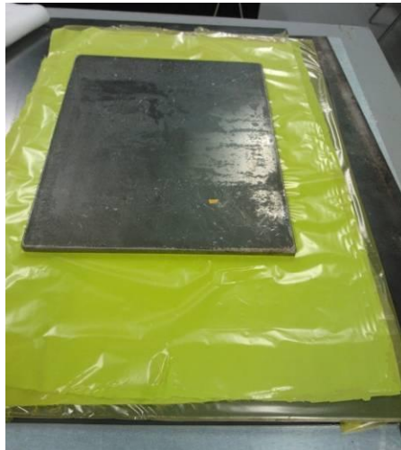
Figura 9: Posizionamento lastra di acciaio superiore
