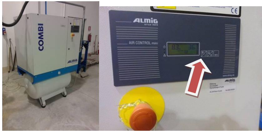
Figura 22: Compressore dedicato all'autoclave e Monitor del compressore dedicato dell'autoclave
