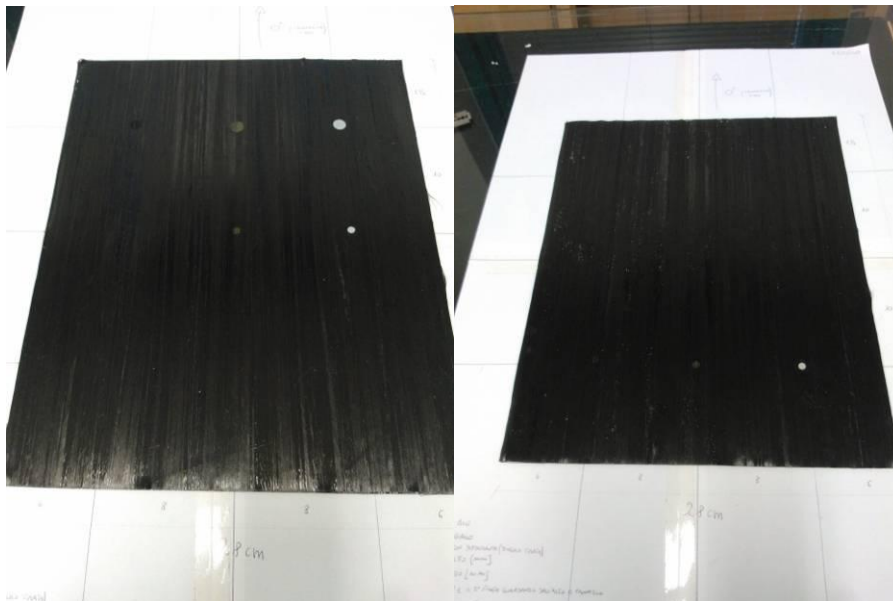
Figura 5: Esempi di posizionamento di elementi di teflon e alluminio per generare discontinuità nel laminato.
