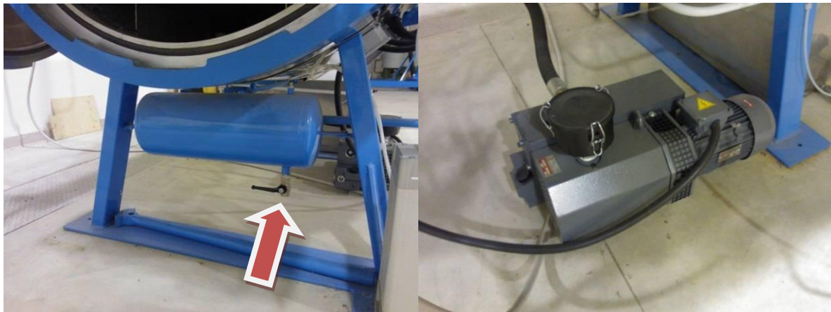
Figura 30: Rubinetto del serbatoio del vuoto e motore della pompa del vuoto
