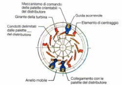
Turbina a geometria variabile
