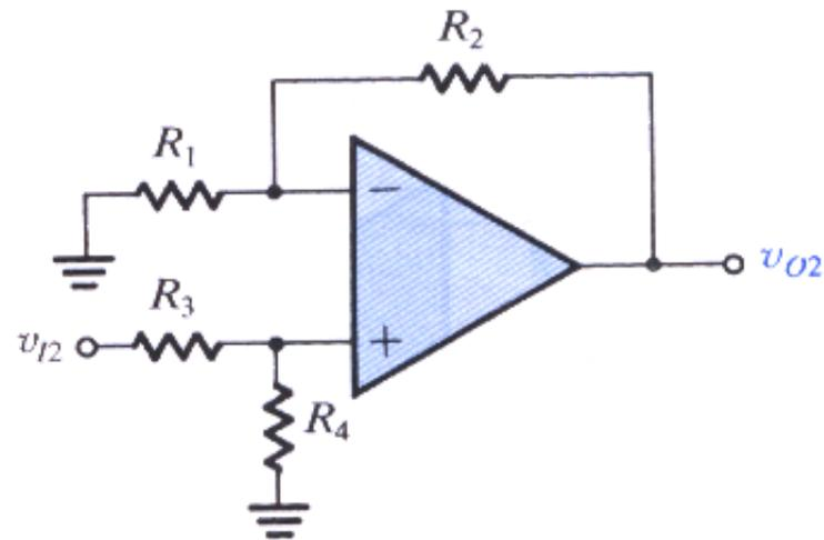
Si dimostra che i due circuiti hanno amplificazione uguale (e quindi vengono amplificati ugualmente i due segnali) se e solo se  $R_2/R_1 = R_4/R_3$ .
