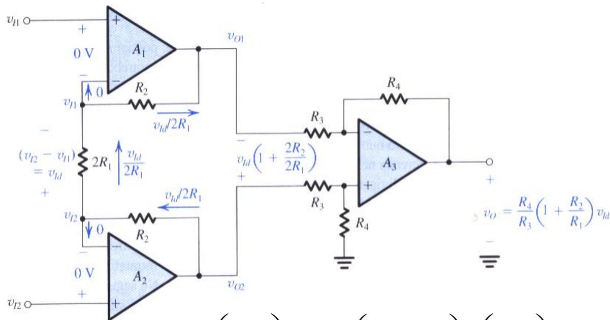
$$v_{Out} = (v_{O2} - v_{O1}) \left( \frac{R_4}{R_3} \right) = v_{id} \left( 1 + \frac{R_2}{R_1} \right) \cdot \left( \frac{R_4}{R_3} \right)$$
