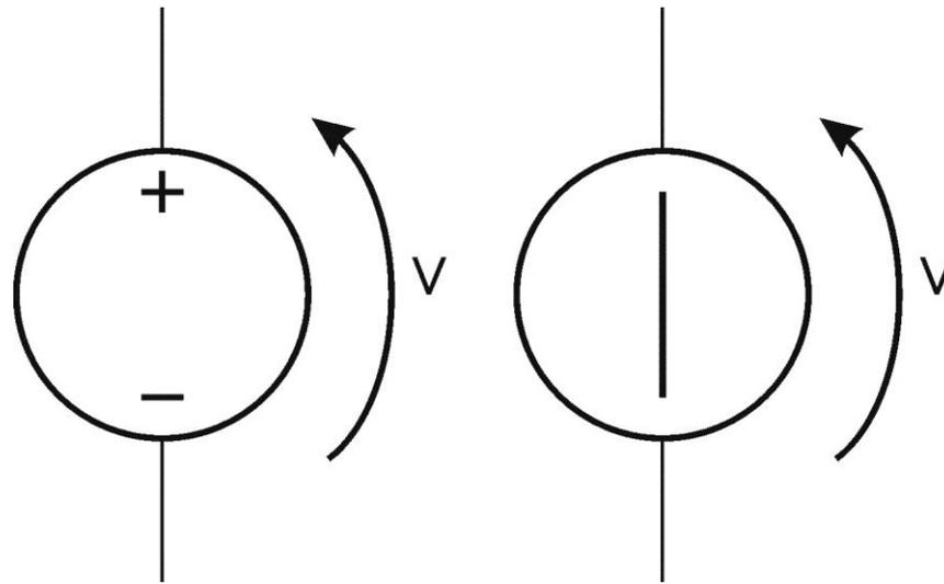
Un generatore di tensione ideale è un componente ai cui capi è sempre presente la tensione nominale, qualunque sia il carico collegato.
