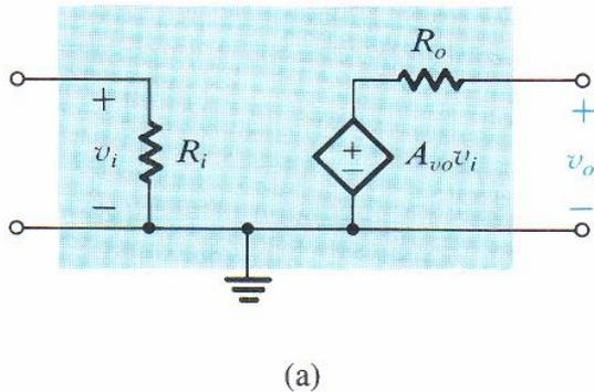
Il simbolo romboidale rappresenta un **generatore pilotato in tensione**, un generatore, cioè, che genera una tensione in uscita proporzionale a un'altra tensione ( $v_i$  in questo caso), tramite un **coefficiente di proporzionalità** ( $A_{vO}$  in questo caso).
