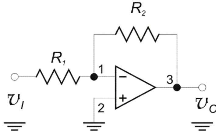
Se faccio la KVL ottengo che  $-V_{R_2} - V_{out} = 0$
