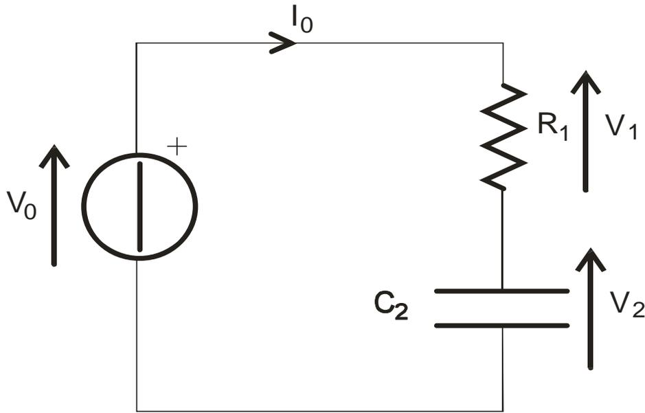
Il circuito può essere risolto mettendo a sistema le relazioni che legano corrente e tensione nei componenti passivi:
