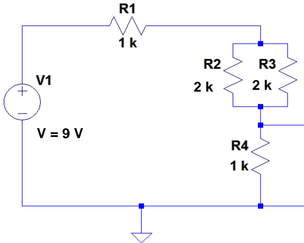
Determinare la tensione ai capi del resistore  $R_4$
