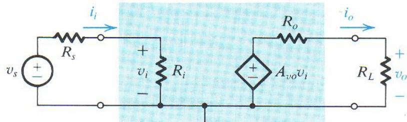
Per rappresentare l'amplificatore inserito in un circuito, **è necessario aggiungere un generatore di tensione** (con la sua resistenza in serie) **e un carico**, rappresentabile con una resistenza  $R_L$ .
