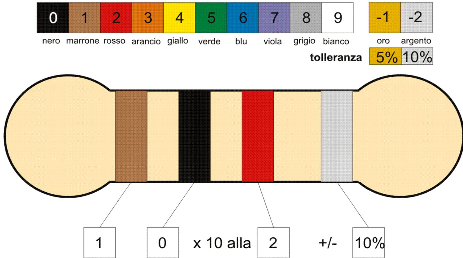
Il resistore disegnato in figura avrà quindi un valore di resistenza di 1000 ohm, con una **tolleranza del 10%**, cioè di 100 ohm, quindi potrà avere (a seconda delle caratteristiche del processo di fabbricazione) un **valore compreso tra 900 e 1100 ohm**
