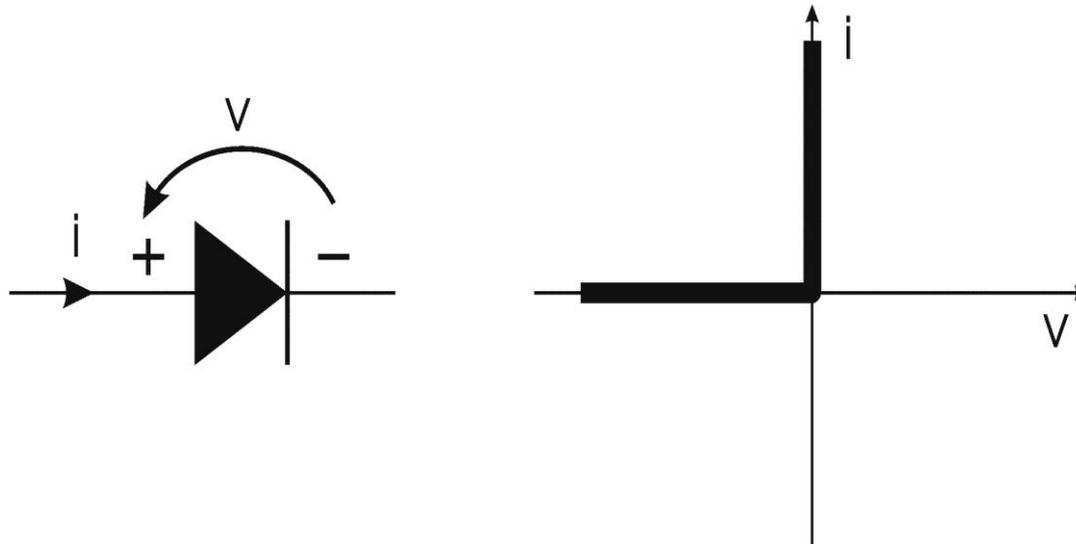
Il diodo è un componente elettronico non lineare a due terminali.
