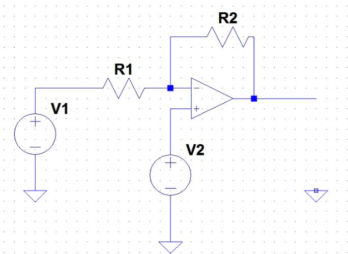
Se  $V_2 = 0$ , ho una configurazione invertente, da cui
