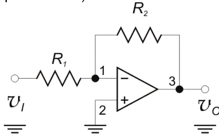
Se si suppone di avere guadagno infinito e  $v_0$  finita, bisogna supporre che  $v_2 - v_1$  sia circa nulla, cioè di avere sul terminale 1 quella che viene chiamata **massa virtuale**.
