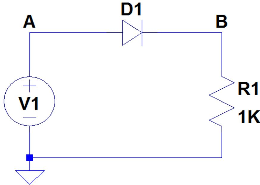
Determinare anche in questo caso come variano  $I$ ,  $V_{R1}$  e  $V_D$  in funzione di  $V_0$
