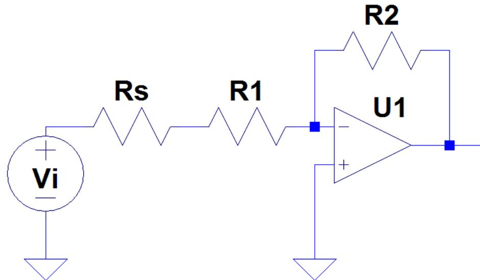
$R_s$  e  $R_1$  sono in serie, per cui possono essere rappresentate da una resistenza equivalente  $R_{eq}=R_s + R_1$
