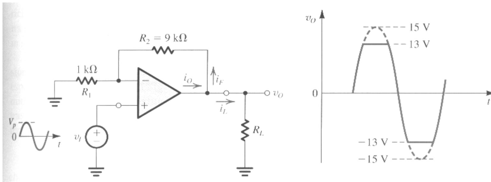
Quando l'operazionale va in saturazione, **non è più in grado di mantenere a zero la differenza di potenziale** tra i due terminali di ingresso
