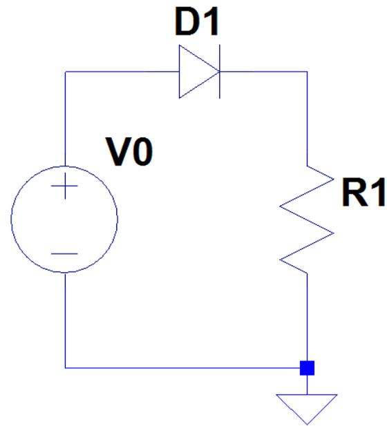
**Come varia  $V_d$  se applico una tensione sinusoidale con ampiezza pari a 5 V?**
