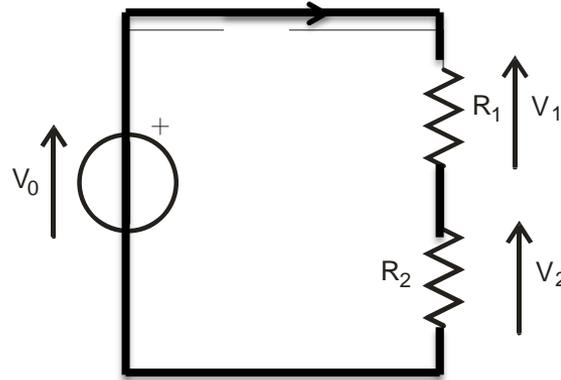
Se consideriamo  $V_0$  come tensione di ingresso e  $V_2$  come tensione di uscita, la relazione ingresso/uscita può essere facilmente scritta come il rapporto tra  $V_2$  e  $V_0$ .
