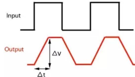
La ragione fisica che determina lo slew rate è legata alle capacità interne del dispositivo ed esiste una relazione con la sua risposta in frequenza.
