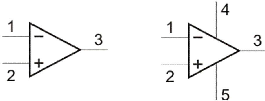
Componente a tre terminali (*ingresso invertente -*, *ingresso non-invertente +*) che **genera in uscita una tensione verso massa** (se il circuito è alimentato dualmente la massa è intesa come il potenziale medio tra quello di 4 e 5)
