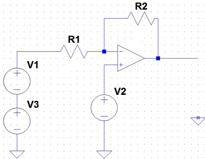
Se  $V_2$  e  $V_3 = 0$ , ho una configurazione invertente, da cui
