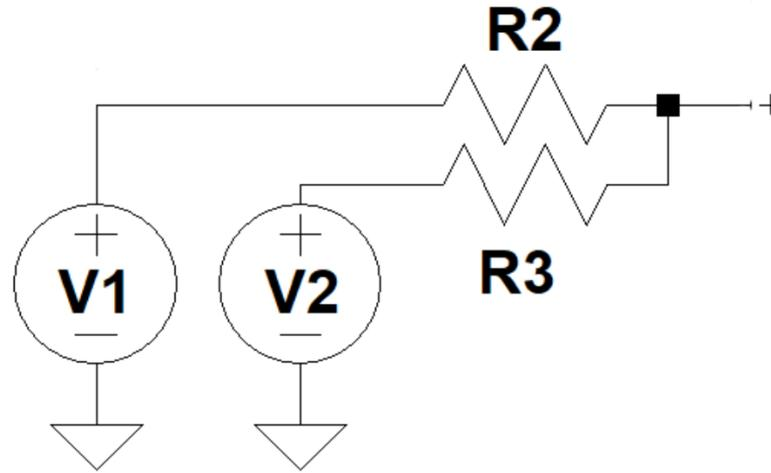
$$V_+ = V_1 \left( \frac{R_3}{R_2 + R_3} \right) + V_2 \left( \frac{R_2}{R_2 + R_3} \right)$$
