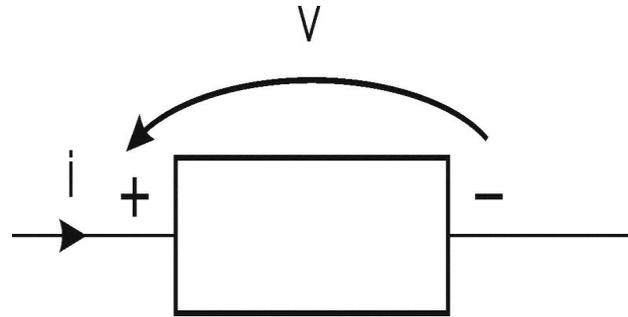
La tensione, o differenza di potenziale, può essere definita come la diminuzione di energia che subisce un'unità di carica quando viene portata dal terminale + al terminale - di un elemento
