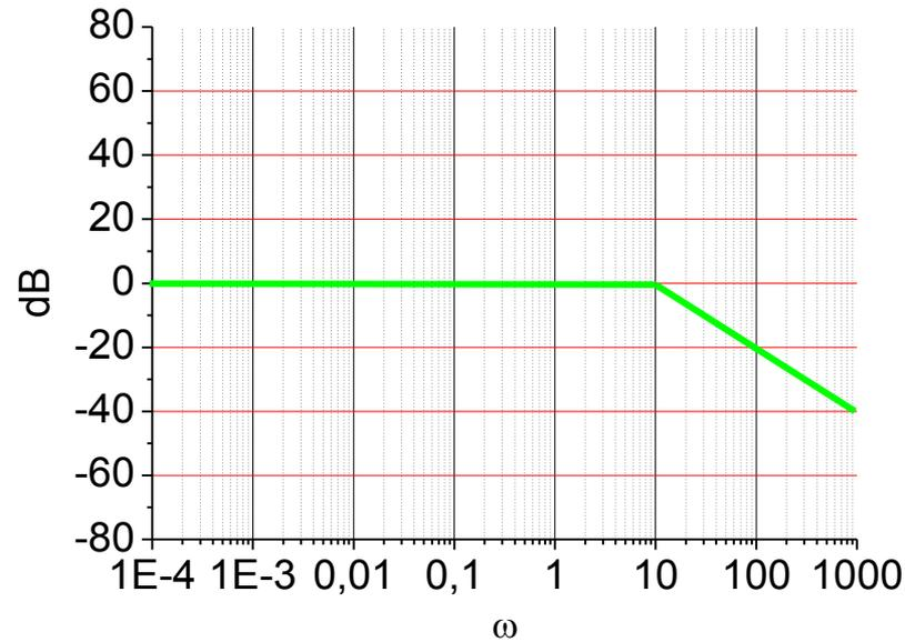
Se mando in ingresso a questo circuito una sinusoide con pulsazione superiore a 10 rad/sec, l'uscita è attenuata, e all'aumentare della pulsazione si attenua sempre di più
