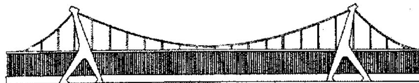
*Fig. 6.11 Copertura a ponte sospeso.*
