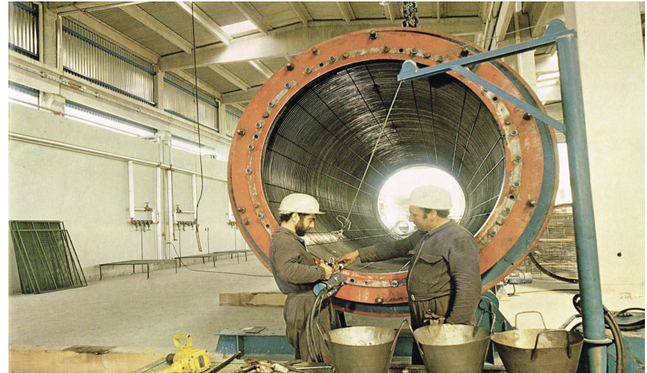
fissaggio cavi di precompressione longitudinale
