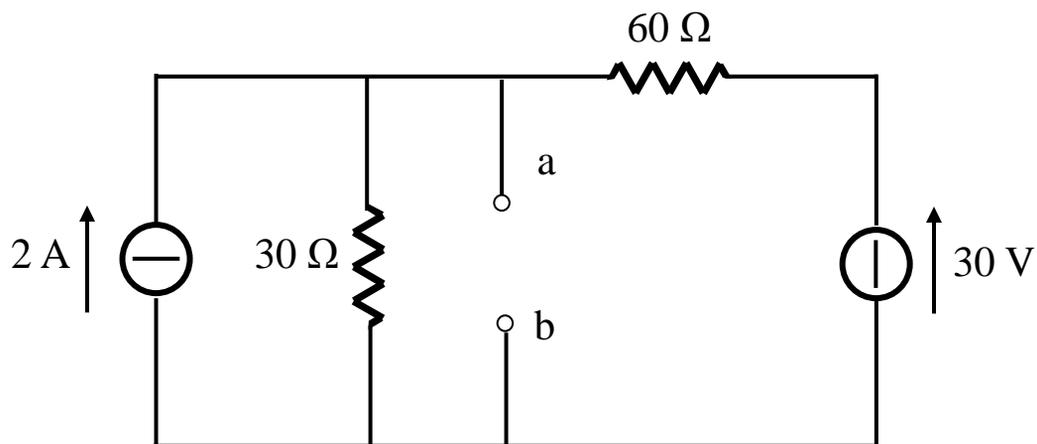
Usando l'analisi nodale, determinare  $v_0$ :
