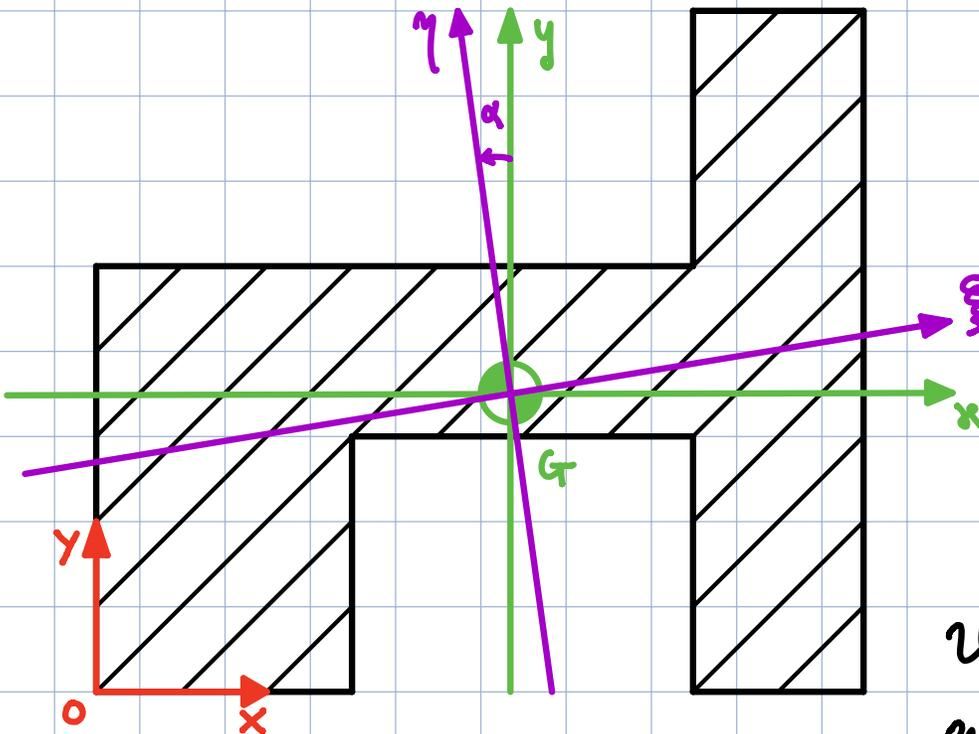
Puotando il sistema  $Gx, y$  di  $\alpha$  in senso CCW si ottiene la configurazione  $G\xi, \eta$ , anche e i momenti principali  $I_{\xi}$  e  $I_{\eta}$ .
