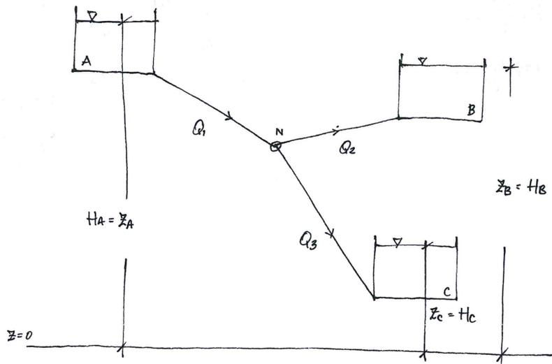
Determinare  $z_B$  tale che  $Q_2$  sia nulla (tubi usati/nuovi) e le portate  $Q_m$  nel caso  $z_A = z_B$ , in caso di tubi nuovi/usati.
