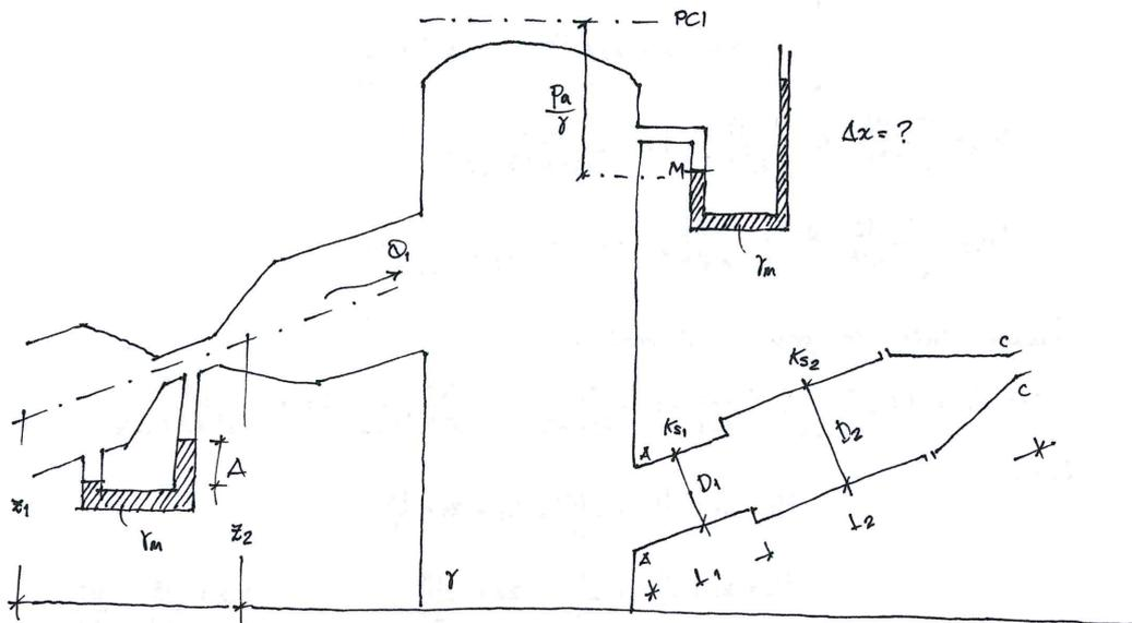
Per determinare la misura del manometro semplice, scrivo la pressione nel manometro e nel serbatoio:
