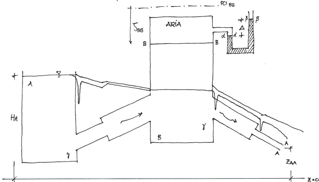
Per trovare l'indicatore del manometro ( $\Delta$ ) devo trovare il piano dei carichi idrostatici del serbatoio B. Posso impostare un sistema a 2 equazioni e 2 incognite che sono la portata  $Q$  (che è uguale sia da A a B che da B alla sezione A-A in quanto moto stazionario) e la quota piezometrica del serbatoio B. Il sistema si scrive nel seguente modo; Prendiamo:
