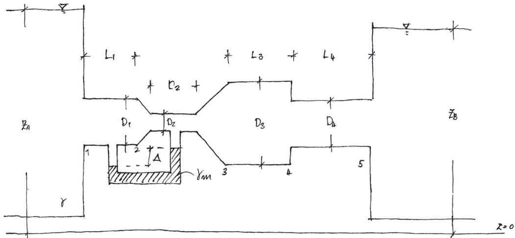
Possiamo prima di tutto determinare la portata attraverso il venturimetro; applico allora l'equazione dell'energia meccanica:
