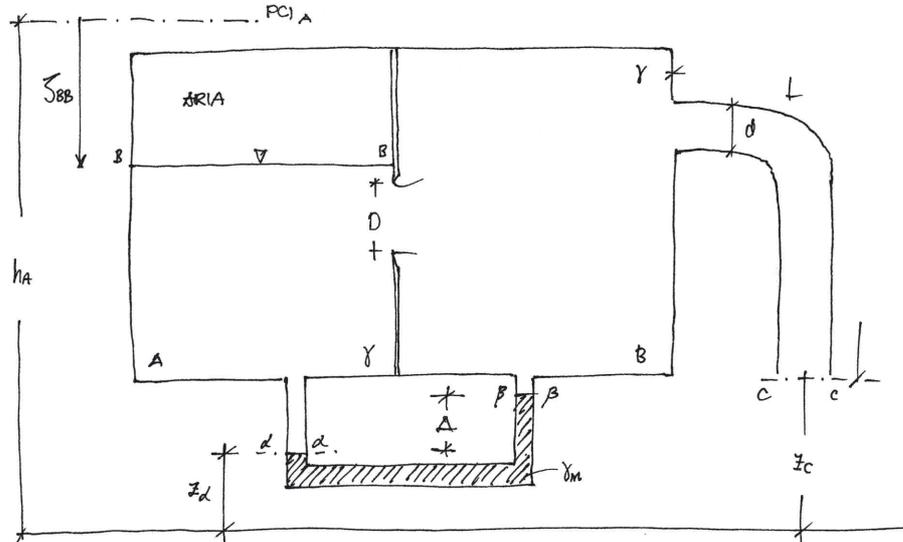
Devo trovare la pressione dell'aria.  $P_A$  sarà uguale alla pressione che ho nel piano BB che è facilmente individuabile conoscendo il PCI del serbatoio B. Per trovare il PCI del serbatoio A devo conoscere il PCI del serbatoio B. Per farlo scrivo l'espressione delle perdite di carico tra il serbatoio B e la sezione contratta CC:
