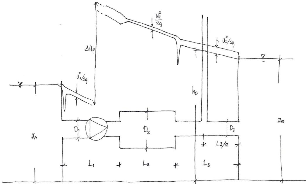
Nota la geometria, determinare la lettura del piezometro ( $h_c$ ).
