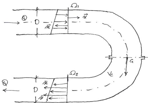
Determinare la spinta laterale per dimensionare i giunti;
