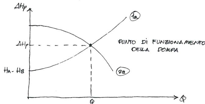
Il punto di funzionamento dice qual'è la portata che transita attraverso l'impianto e qual'è la portata prevalenza della pompa.
