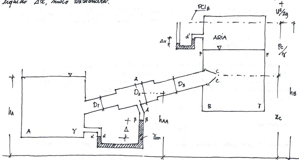
Per trovarmi  $\Delta x$  devo ricavarli il piano dei carichi idrostatici del serbatoio B. Il  $PC/B$  lo posso trovare sottraendo le perdite di carico da  $H_A$  ed avere:
