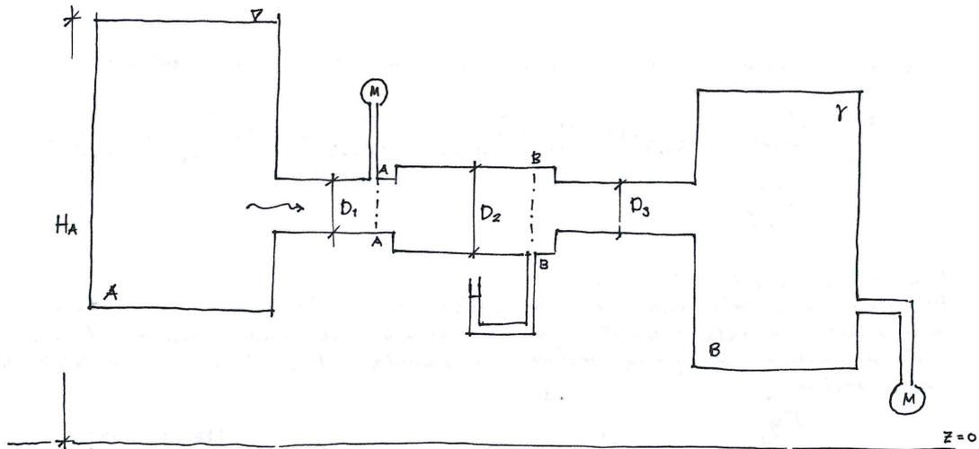
Devo trovare  $H_A$ . Per fare questo posso scrivere l'espressione della perdita di carico del serbatoio A al serbatoio B.
