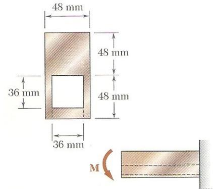
$$A_1 = B \cdot H = 48 \cdot 96 = 4608 \text{ [mm}^2\text{]}; \text{ posizione verticale del baricentro: } y_{g1} = 48 \text{ [mm]}$$
