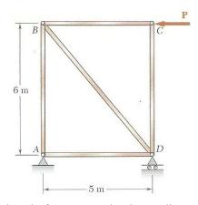
Per calcolare la variazione di lunghezza dell'asta BD è necessario calcolare la forza normale che su di essa agisce: a questo scopo è possibile immaginare la forza P, applicata nel nodo B, come somma di due componenti, una in direzione verticale e l'altra orientata come l'asta BD. Se ne deduce che:
