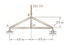
Per calcolare le deformazioni degli elementi AB e AD dobbiamo conoscere le azioni normali che su di essi agiscono. La reazione verticale nel nodo A vale F/2: essa deve essere scomposta in due componenti orientate come le aste AB e AD. Risulta quindi:
