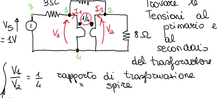
Trovare le Tensioni al primario e al secondario del trasformatore
