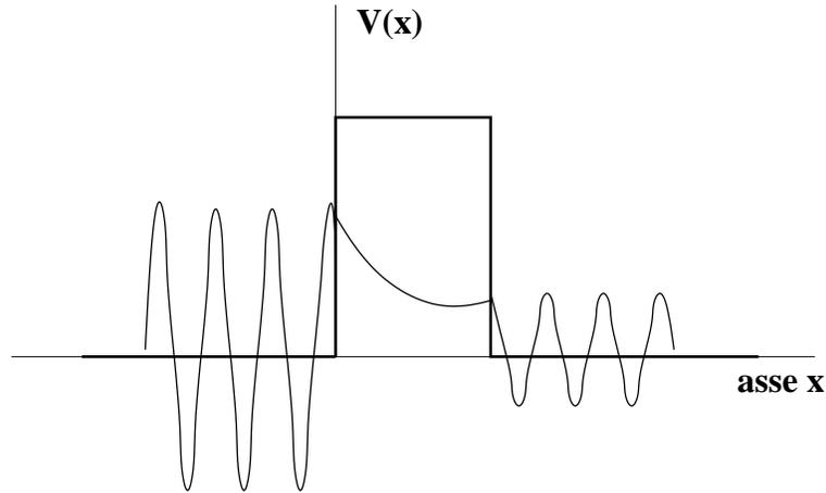
**Figura 2:** Andamento della funzione d'onda per un elettrone di energia  $E$  incidente (da sinistra verso destra) contro la barriera di potenziale di altezza  $E_0 > E$  e di spessore  $a$ .
