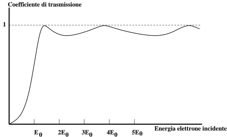
**Figura 3:** Andamento del coefficiente di trasmissione per un elettrone di energia  $E$ , incidente (da sinistra verso destra) contro la barriera di potenziale di altezza  $E_0$  e di spessore  $a$ .
