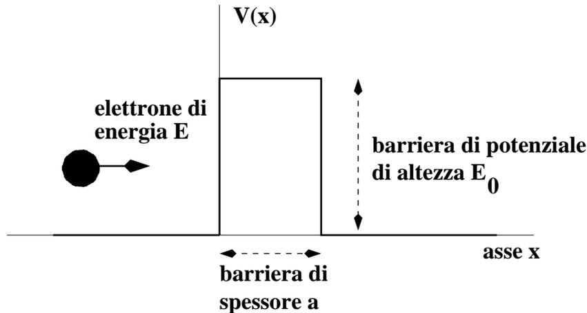
**Figura 1:** L'elettrone di energia  $E$  arriva da sinistra verso destra contro la barriera di potenziale di altezza  $E_0$  e di spessore  $a$ .
