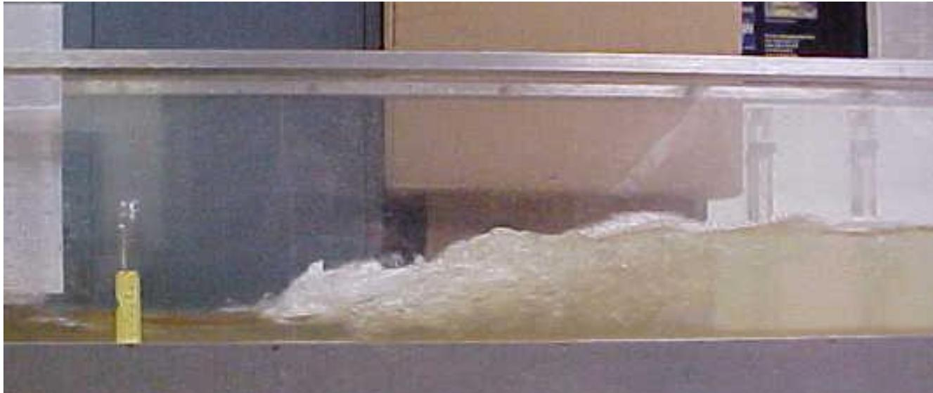
Risalto idraulico: passaggio da corrente veloce a corrente lenta con forte dissipazione energetica
