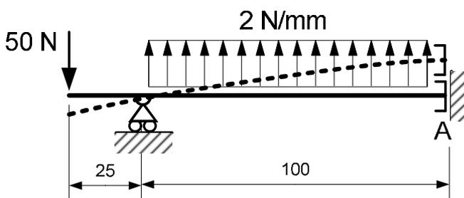
Data la trave di figura (Alluminio;  $E = 70 \text{ GPa}$ ), si richiede di determinare l'equazione della linea elastica nel tratto A-B e di calcolare (sfruttando l'equazione della linea elastica) lo spostamento verticale della sezione C.
