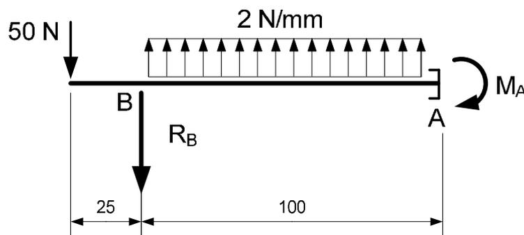
Le reazioni vincolari al carrello a terra in B ( $R_B$ ) ed al pattino a terra in A ( $M_A$ ) possono essere calcolate con semplici equazioni di equilibrio della trave (per esempio alla traslazione in direzione verticale ed alla rotazione intorno al carrello B). Si ricava  $R_B = 150 \text{ N}$  ed  $M_A = 11250 \text{ Nmm}$ .
