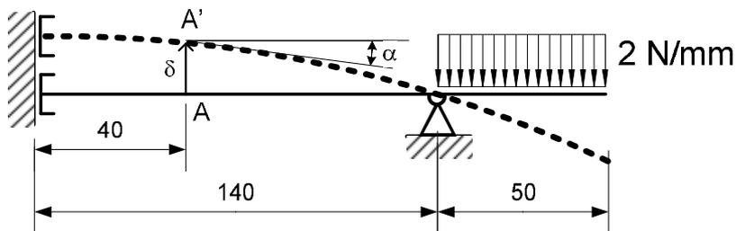
L'equazione (3),  $y = \frac{1}{EJ} \left( 2500 \cdot \frac{x^2}{2} - 2.45E7 \right)$ , permette invece di determinare lo spostamento  $\delta$  del punto A, calcolando il valore di  $y$  per  $x=40$  mm:
