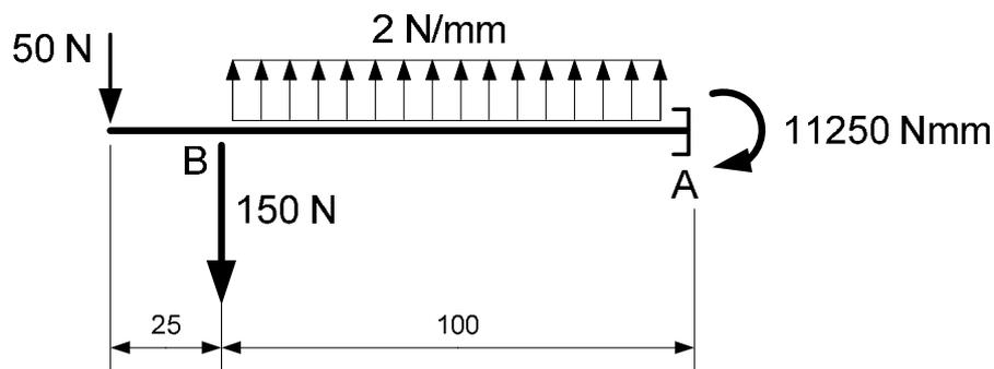
Per calcolare lo spostamento verticale del pattino A è sufficiente scrivere l'equazione della linea elastica nel tratto A-B.
