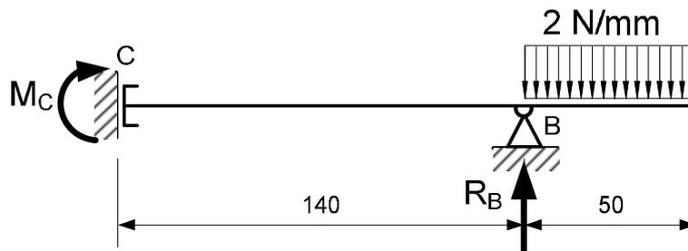
Le reazioni vincolari al pattino a terra C ( $M_C$ ) ed alla cerniera a terra B ( $R_B$ ) possono essere calcolate con semplici equazioni di equilibrio della trave (per esempio alla traslazione in direzione verticale ed alla rotazione intorno al punto B).
