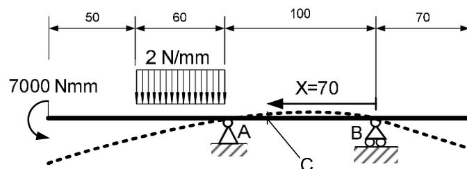
Calcolare la rotazione (in gradi) della linea d'asse della struttura nel punto A utilizzando l'equazione della linea elastica. Materiale: acciaio ( $E=210 \text{ GPa}$ )
