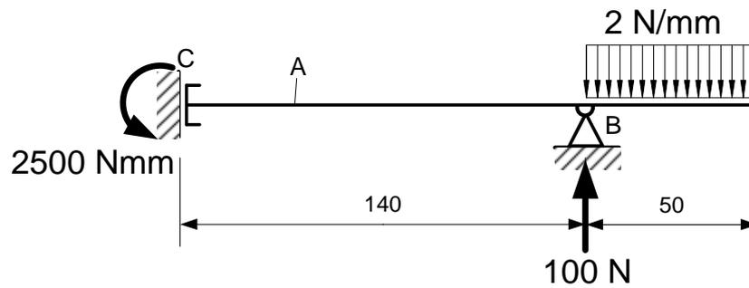
Per calcolare la rotazione della trave nel punto A possiamo scrivere l'equazione della linea elastica nel tratto C-B.
