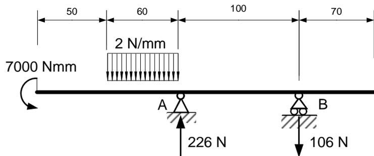
Per calcolare lo spostamento verticale della trave nel punto C è sufficiente utilizzare l'equazione della linea elastica nel tratto A-B.
