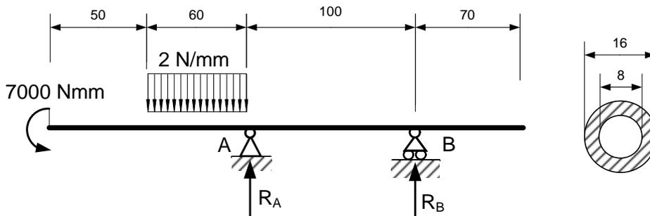
Le reazioni vincolari al carrello a terra in B ( $R_B$ ) ed alla cerniera a terra in A ( $R_A$ ) possono essere calcolate con semplici equazioni di equilibrio della trave (per esempio alla rotazione intorno al punto A ed alla traslazione in direzione verticale).
