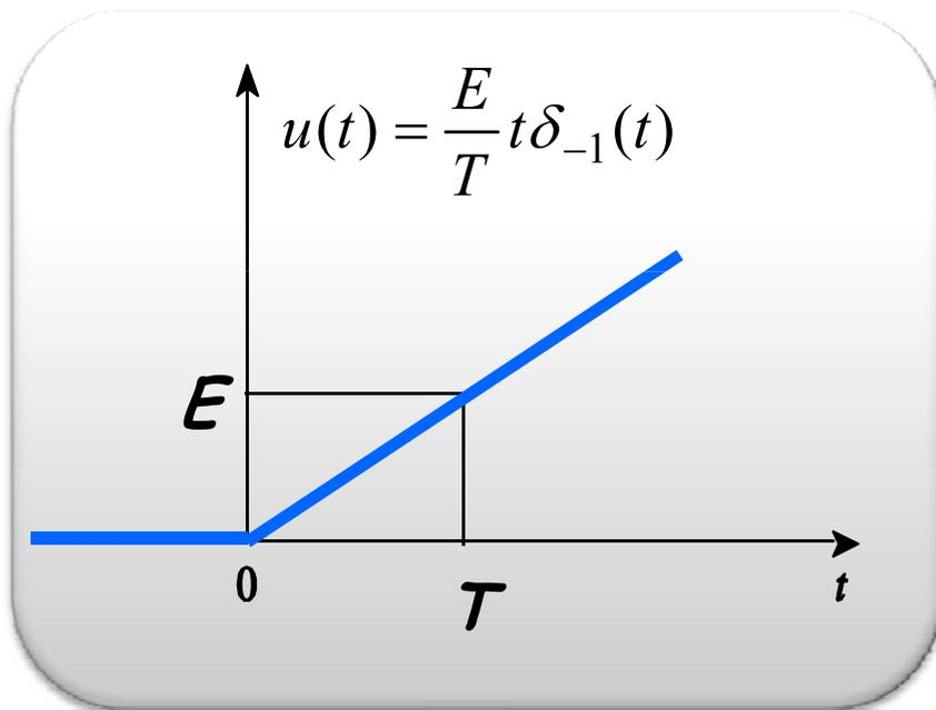
Se conosco l'uscita relativa all'ingresso a gradino posso calcolare l'uscita alla rampa integrando opportunamente la precedente uscita
