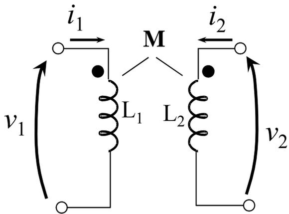
$$\begin{cases} v_1 = L_1 \frac{di_1}{dt} + M \frac{di_2}{dt} \\ v_2 = M \frac{di_1}{dt} + L_2 \frac{di_2}{dt} \end{cases} \Rightarrow \begin{bmatrix} L_1 & M \\ M & L_2 \end{bmatrix} \cdot \begin{bmatrix} \frac{di_1}{dt} \\ \frac{di_2}{dt} \end{bmatrix} = \begin{bmatrix} v_1 \\ v_2 \end{bmatrix} \Rightarrow$$
