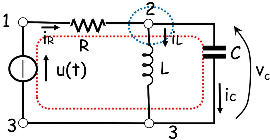
$$\underline{x} = \begin{bmatrix} v_c \\ i_L \end{bmatrix} \quad \text{vettore di stato}$$
