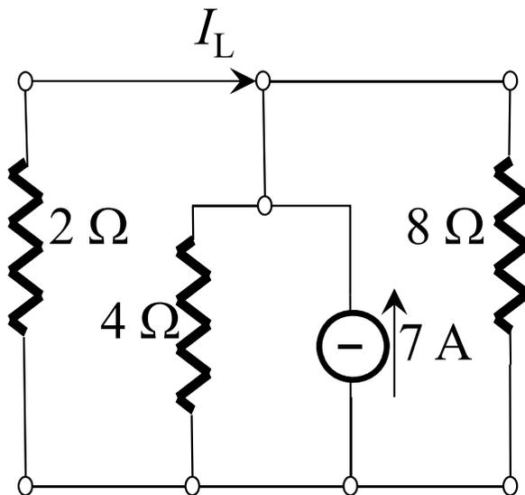
Per calcolare  $i_L(0^-)$  e  $v_C(0^-)$  posso applicare il partitore resistivo di corrente
