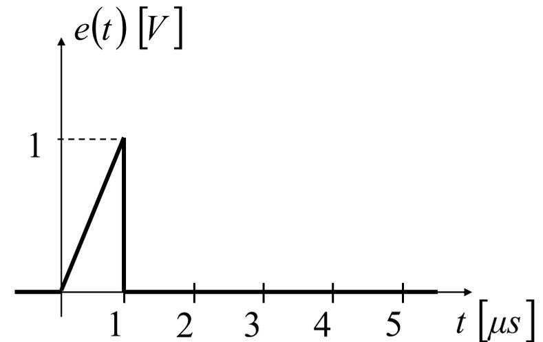
Calcolare la tensione  $v(t)$  nella rete in figura nell'intervallo  $0 < t < 1\mu s$  e tracciarne il grafico. Si suppone che il generatore di tensione abbia la forma d'onda indicata in figura.
