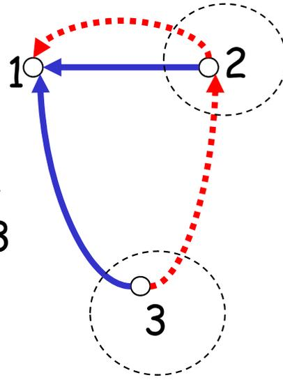
$$\text{Eq. TOP.} \begin{cases} i_1 + i_c - i_2 = 0 \\ i_u + i_2 = 0 \\ v_u - v_c - v_2 = 0 \\ v_c - v_1 = 0 \end{cases}$$
