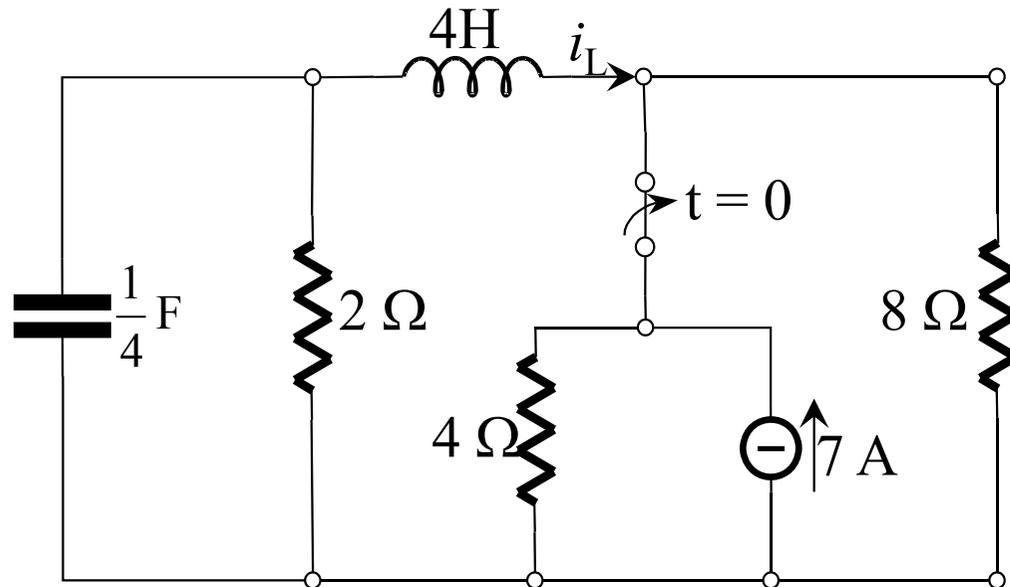
Dato il circuito in figura calcolare  $i_L(t)$  per  $t > 0$
