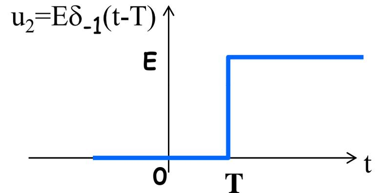
Se  $u(t) = u_1 - u_2$  posso trovare l'uscita di un circuito per un ingresso rettangolare sottraendo le uscite relative ai due ingressi a gradino
