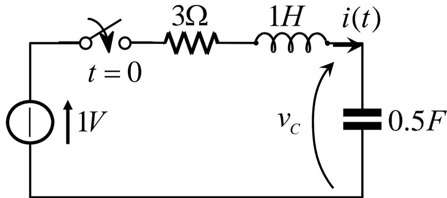
Ricavare la corrente  $i(t)$  per  $t > 0$  sapendo che lo stato del circuito in  $t = 0^-$  è nullo
