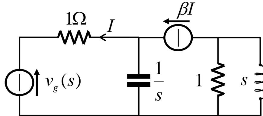
Semplifichiamo il circuito sostituendo al parallelo del resistore e della induttanza un'impedenza equivalente
