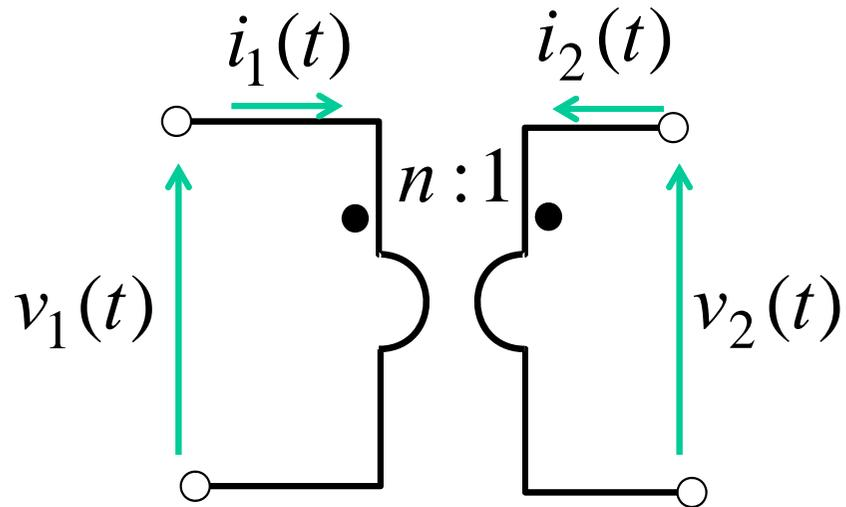
$$\begin{cases} v_1(t) = n \cdot v_2(t) \\ i_1(t) = -\frac{1}{n} \cdot i_2(t) \end{cases}$$
