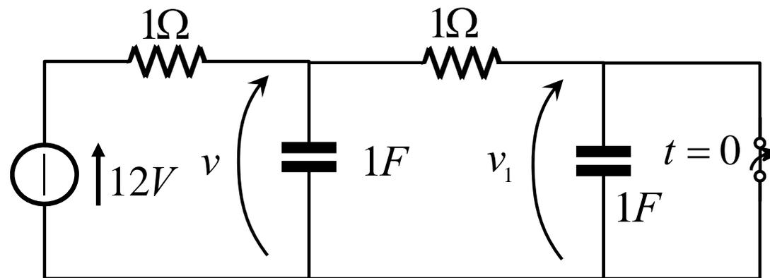
Per  $t > 0$  disegniamo il circuito nel dominio di Laplace scaricando il condensatore.
