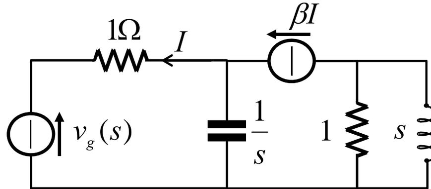
La funzione di trasferimento  $\frac{V_1}{V_g}$  ha un polo  $p = \beta - 1$
