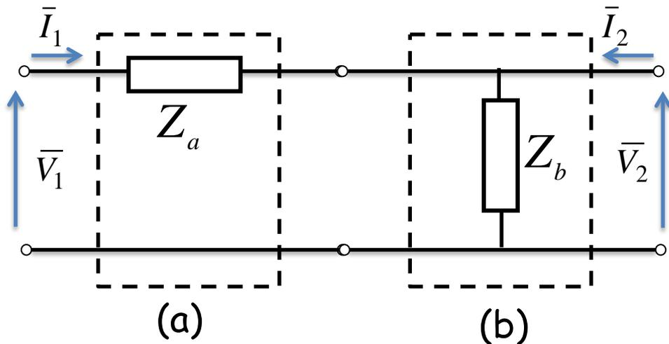
Utilizzando le regole per il collegamento di doppi-bipoli, ricavare la matrice  $[T]$  del doppio-bipolo ad  $L$  in figura.
