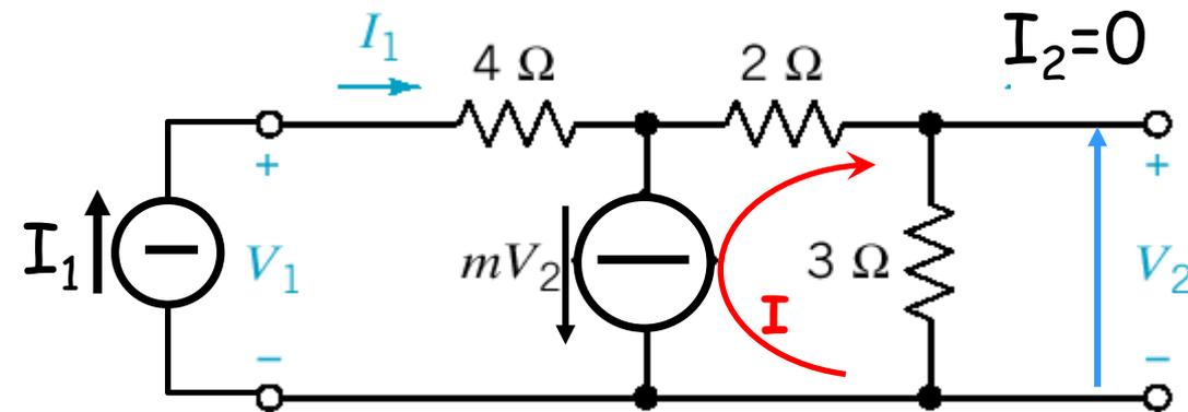
$$\begin{cases} I_1 - m \cdot V_2 = I \\ V_1 = 4I_1 + 5I \Rightarrow \\ V_2 = 3I \end{cases}$$
