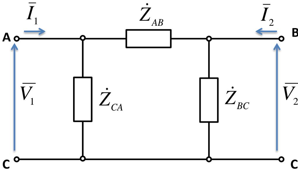
$$[\dot{Y}] = \begin{bmatrix} \dot{Y}_{AB} + \dot{Y}_{CA} & -\dot{Y}_{AB} \\ -\dot{Y}_{AB} & \dot{Y}_{BC} + \dot{Y}_{AB} \end{bmatrix}$$
