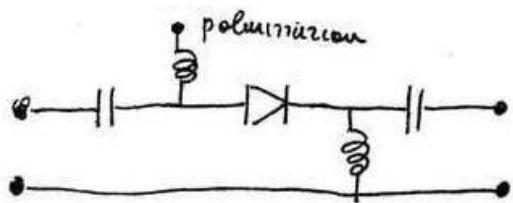
Nel circuito a lato i condensatori servono a bloccare la continua e le incaltanze a condurlo (bloccano il segnale)
