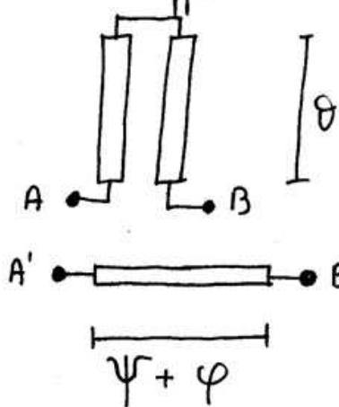
I punti A, A' sono gli ingressi e B, B' le uscite, e il segnale in B' deve essere sfasato di  $\varphi_0$  rispetto a quello in B a centro banda
