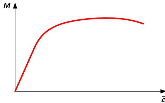
Fig. 2: Curva  $M-\bar{\varepsilon}$  ricavata dalla prova di flessione
