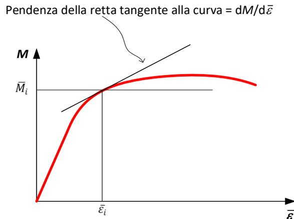
Fig. 4: Curva  $M - \bar{\epsilon}$  e rappresentazione grafica del termine  $\frac{dM(\bar{\epsilon})}{d\bar{\epsilon}}$
