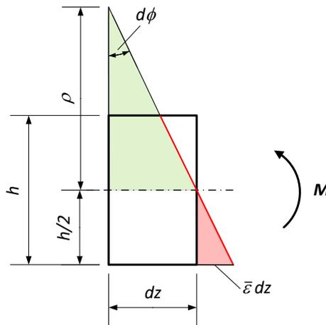
Fig 6: Deformazione flessionale in un elemento infinitesimo di trave di lunghezza  $dz$
