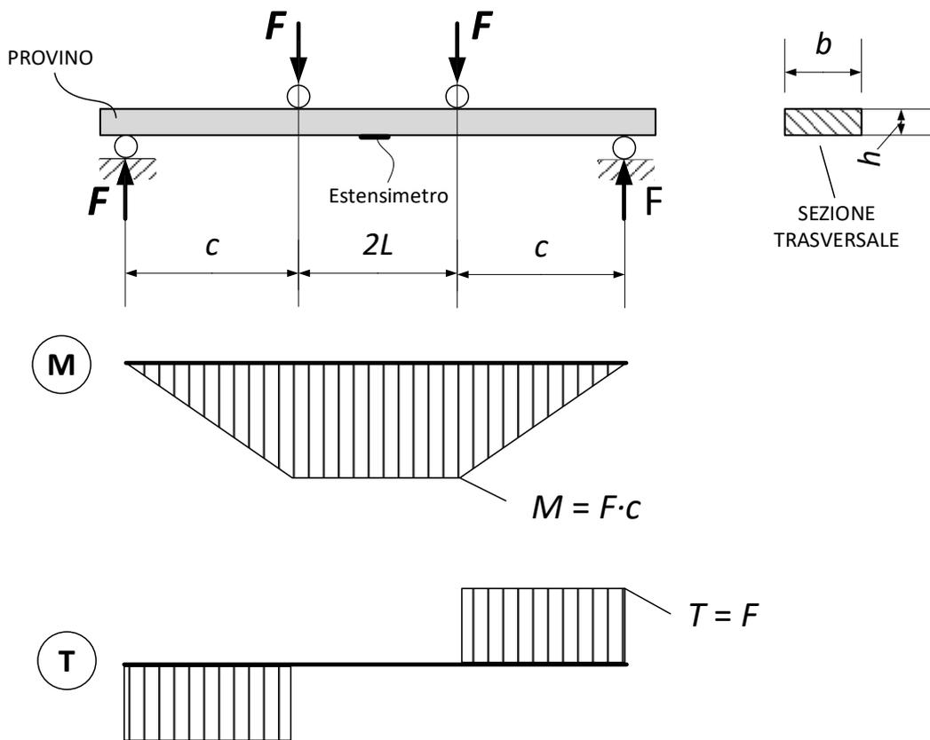
Fig. 1: Schema statico di una prova di flessione a 4 punti
