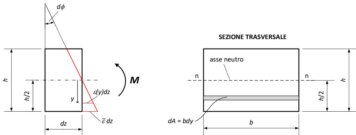
Fig. 3: Deformazione di un elemento di trave di lunghezza infinitesima  $dz$
