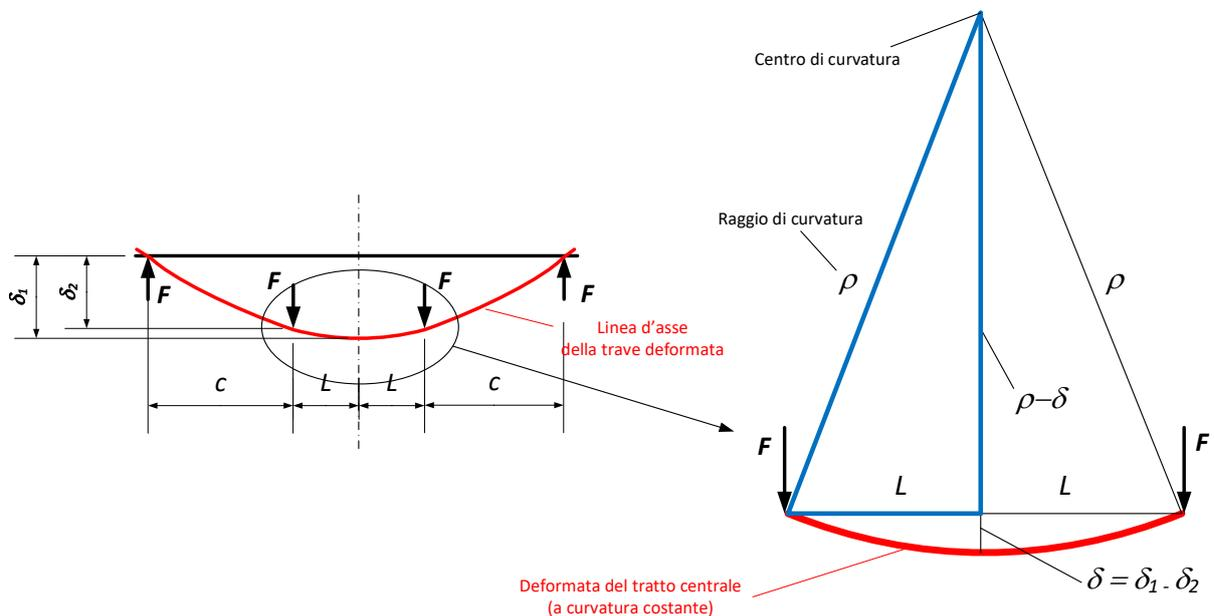
Fig. 5: Deformata della linea d'asse del provino sottoposto a flessione su 4 punti
