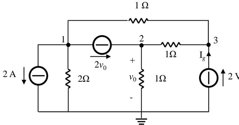
Verificare la conservazione della potenza complessa nel circuito in figura. Si consideri la tensione del generatore indipendente espressa tramite il suo valore massimo.
