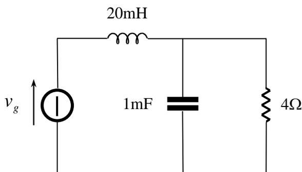
Dato il circuito in figura trovare l'espressione di  $i_o(t)$  per  $t > 0$ . Riportare lo studio delle condizioni iniziali dei componenti con memoria.
