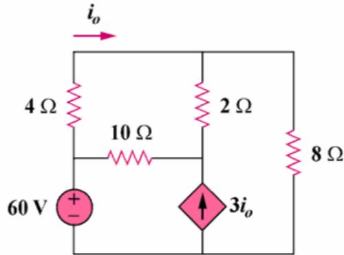
Nel circuito in figura determinare la corrente  $I_s$  sapendo che il generatore di tensione fornisce una potenza  $\dot{S} = 2.5 + j0.4 \text{ VA}$
