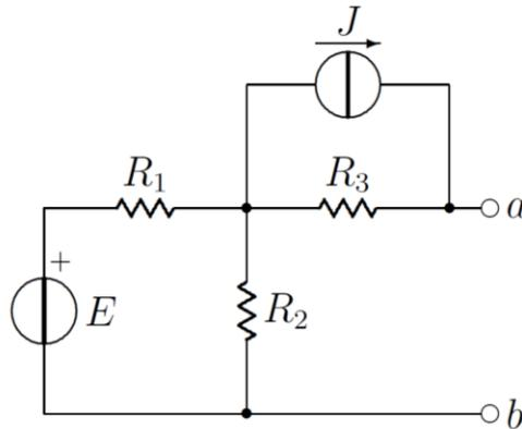
Nel circuito in figura ricavare  $\bar{I}_0$  e calcolare la potenza complessa degli elementi passivi.
