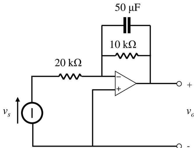
Usare la trasformazione dei generatori per ridurre il circuito in figura ad un generatore di tensione in serie con una resistenza rispetto ai terminali  $a-b$ .
