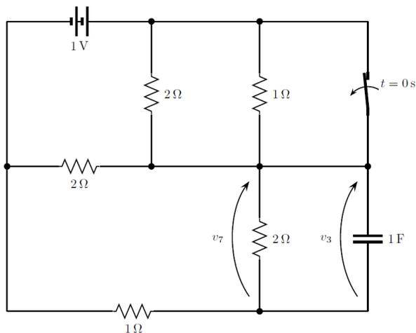
In  $t < 0$  il tasto è chiuso. In  $t = 0$  il tasto si apre. Determinare  $v_3(t)$  per  $t > 0$ .
