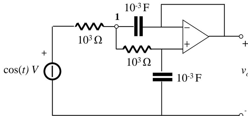
Applicare il teorema di Thévenin ai morsetti a,b del circuito in figura. Ricavare l'equivalente di Norton applicando il metodo della trasformazione della sorgente.
