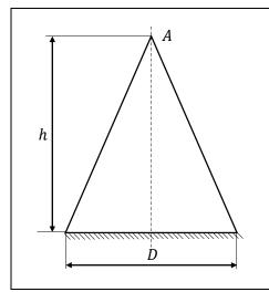
Determinare lo spostamento del vertice A di un cono circolare omogeneo di altezza h, diametro massimo D, densità  $\rho$  e modulo di elasticità E, dovuto al suo peso proprio.
