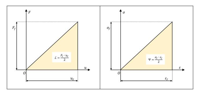
Sempre nel caso di un materiale elastico lineare, è possibile definire l'energia accumulata da un volume unitario, detta anche DENSITA' DI ENERGIA DI DEFORMAZIONE:
