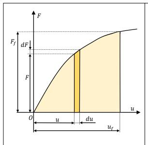
Nel caso della trazione, ipotizzando che il carico F cresca lentamente da zero al valore finale, cioè in maniera quasi statica, attraverso una successione di stati di equilibrio, gli estremi della trave si allontanano della quantità u. Un aumento infinitesimo del carico dF rispetto al valore di partenza F, provoca un allungamento du. In questo intervallo il lavoro di F vale  $F \cdot du$ .
