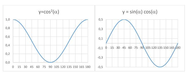
Lo sforzo normale  $\sigma_n$  è massimo per  $\alpha=0^\circ$  ed è nullo per  $\alpha=90^\circ$ .
