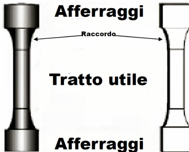
Nel caso di provini cilindrici, la norma fissa in modo rigoroso le proporzioni tra gli elementi geometrici (lunghezza  $L_0$  del tratto utile, diametro  $d$  della sezione circolare di area  $S_0$ ):
