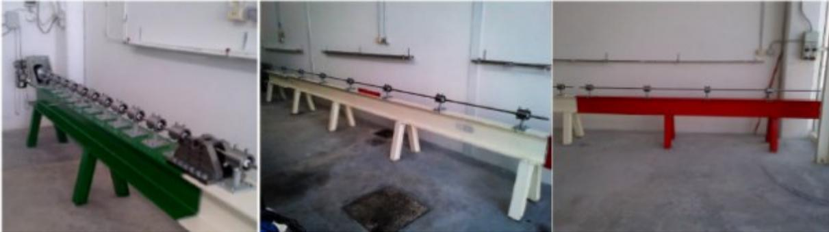
Barra di Hopkinson per prove ad alte velocità di deformazione.
